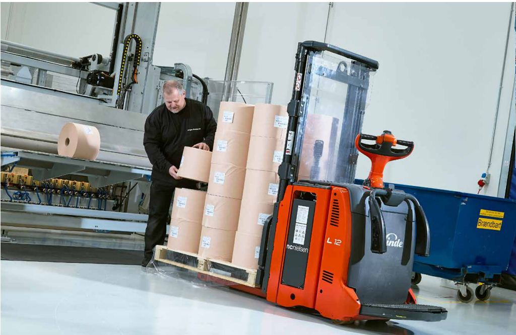
Sikkerheden er højt prioriteret hos Fibertex Personal Care, og de nye Linde el-truck er udstyret med blandt andet bakkamera, ekstra spejle og Blue Spot-lyskegle.
