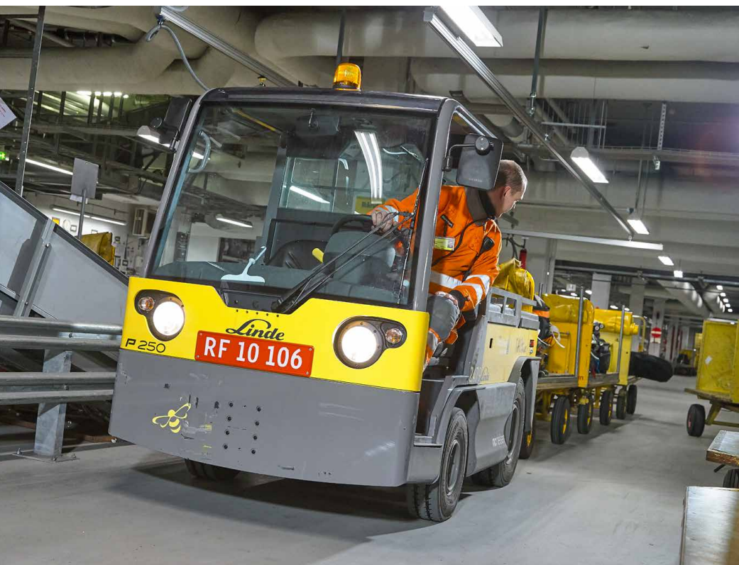
Linde P250 el-traktor uden kabinedøre giver stort overblik for føreren og gør det nemmere at stige ind og ud af den kompakte førerkabine.
