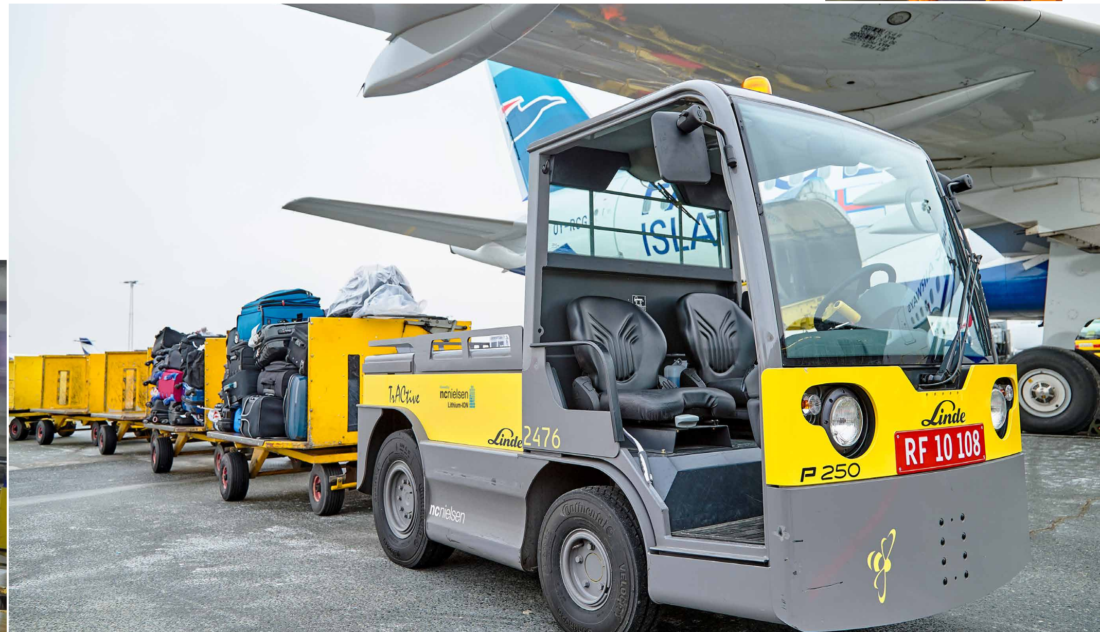
Platformen foran terminalbygningen er det travle samlingspunkt, når flyene på rekordtid skal tømmes for passagerer og bagage – for igen at blive klar til næste afgang. Linde P250 el-traktorer sørger for en sikker transport af bagagevognene med en maksimal hastighed på 20 km/t.
