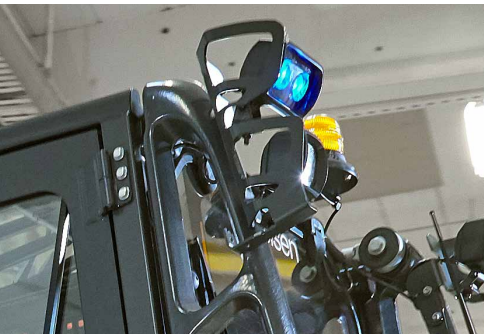
Sikkerheden er højt prioriteret hos Fibertex Personal Care, og de nye Linde el-truck er udstyret med blandt andet bakkamera, ekstra spejle og Blue Spot-lyskegle.
