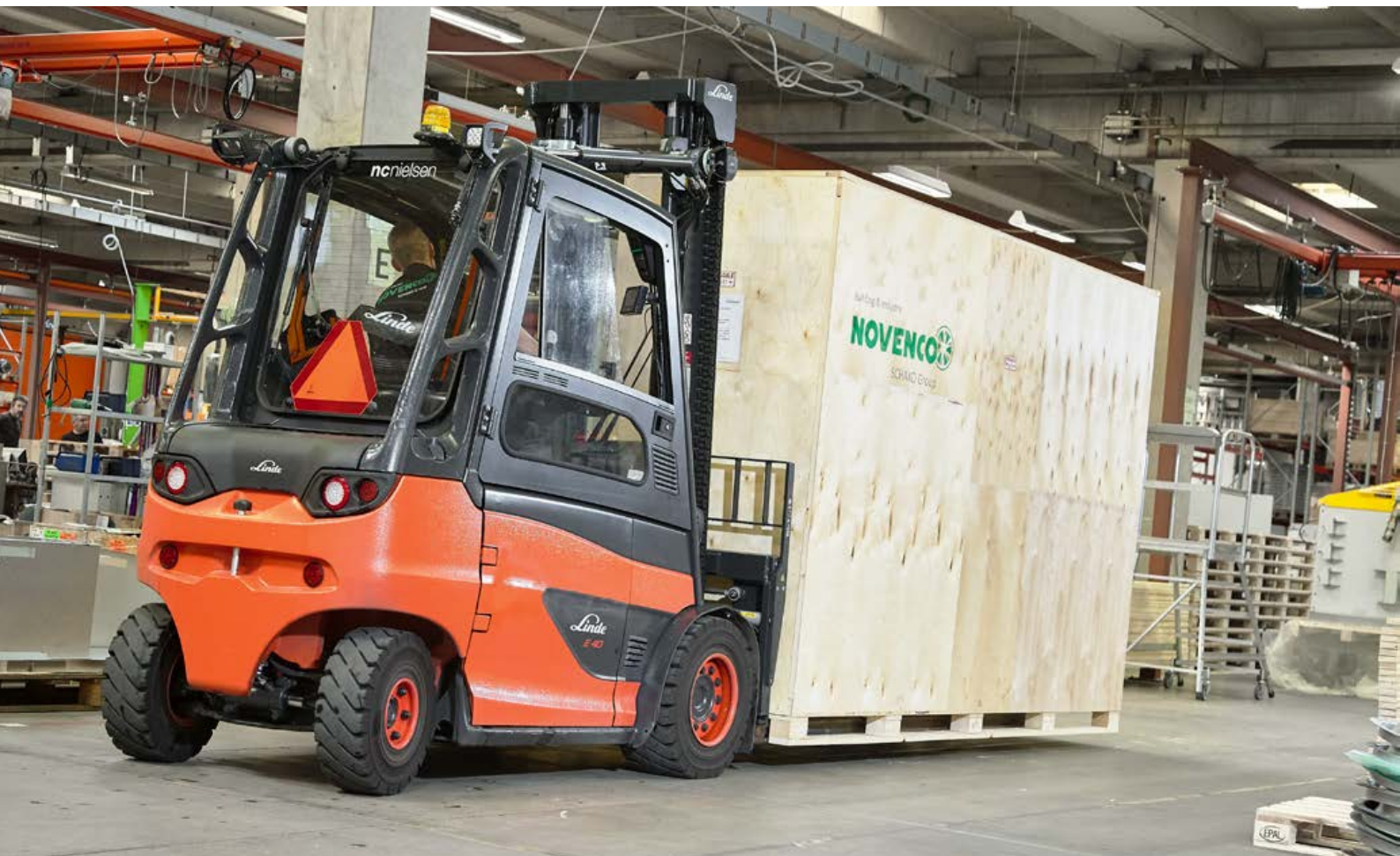
To bomstærke og eldrevne Linde E40/600H modvægtstruck flytter snildt ventilationsblokke til datacentre, der vejer lige over 3,6 ton.
