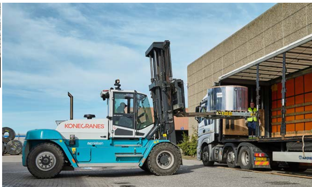
En Konecranes SMV 16-1200 C kan nemt håndtere en stålcoil på palle med en vægt på 12 ton.
