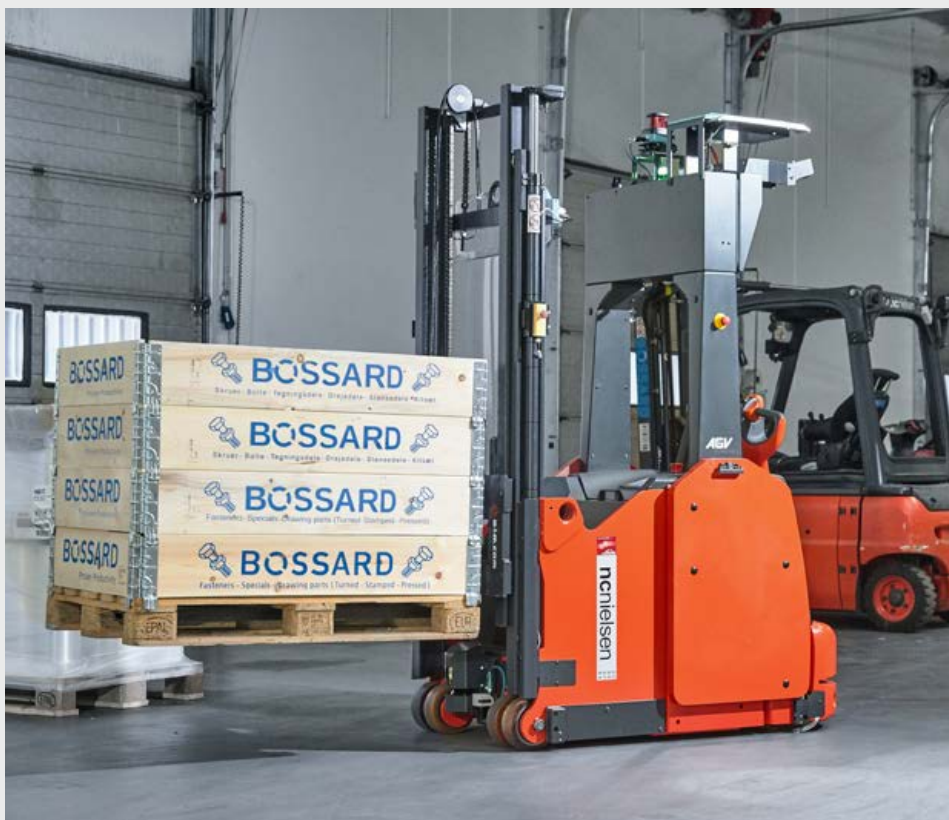
I forsendelsesafdelingen prøvekører Bossard Denmark A/S denne selvkørende Linde L14 el-stabler, der blandt andet skal køre med papbure, tomme rullebånd, ranke paller og stable paller i det frie rum.
