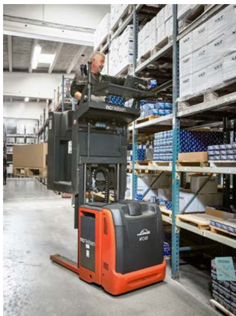
Basen på ITW BYG-lageret er 20 styk Linde V08-02/1110 ordreplukkere, der hurtigt, sikkert og præcist kan håndtere plukkeopgaver med truckføreren hævet i op til 1,2 meters højde.
