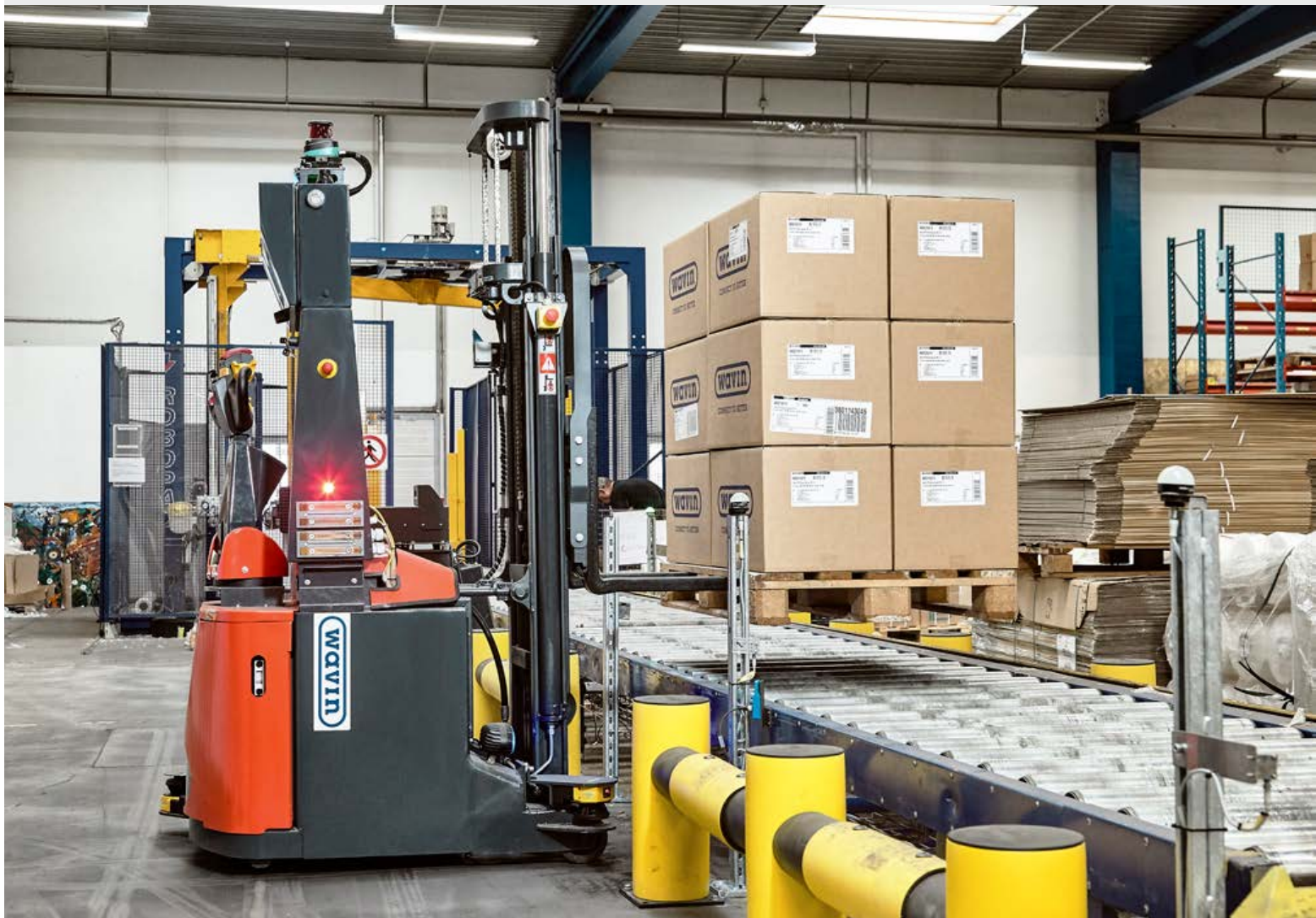
En innovativ AGV-løsning fra N.C. Nielsen har effektiviseret arbejdsgangen hos Wavin, hvor den selv-kørende stabler fragter paller med fittings fra sprøjtestøberiet til en folieringsmaskine døgnet rundt.
