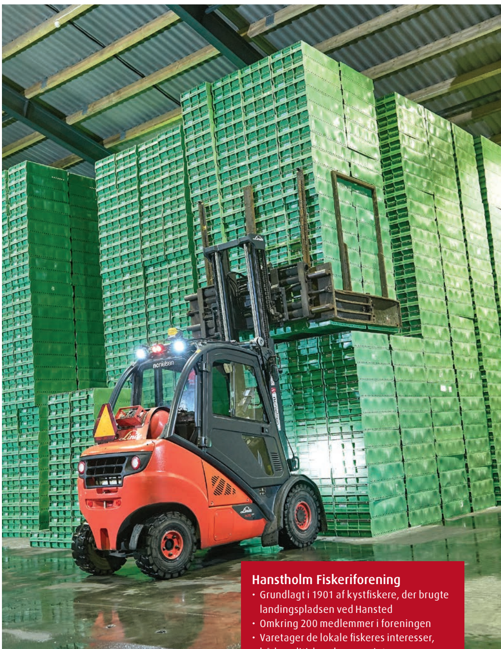
En Linde H25T/393 gastruck med klemmer og støttebøjler kan nemt håndtere 150 tomme fiskekasser med en samlet vægt på omkring 950 kg.
