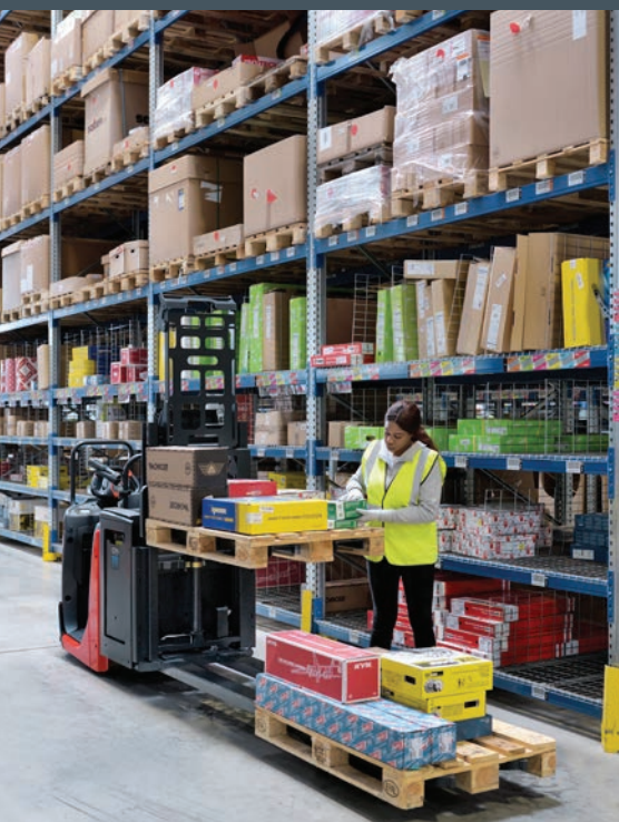
Linde N20 kan leveres som dobbelte stablervarianter eller med ekstra lange gafler til to paller i samme niveau – hermed kan flere ordre ekspederes samtidigt.
