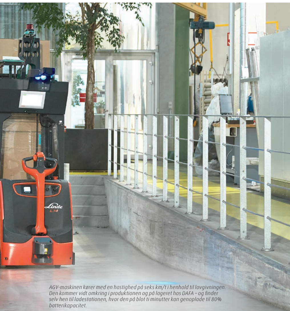
AGV-løsningen hos DAFA kan blokstable i det frie rum og placere varepaller oven på hinanden, så de op i en højde af 4,4 meter.
