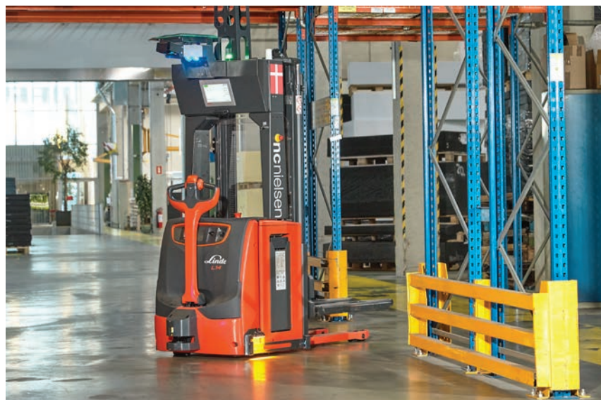
AGV-maskinen kører med en hastighed på seks km/t i henhold til lovgivningen. Den kommer vidt omkring i produktionen og på lageret hos DAFA – og finder selv hen til ladestationen, hvor den på blot ti minutter kan genoplade til 80% batterikapacitet.
