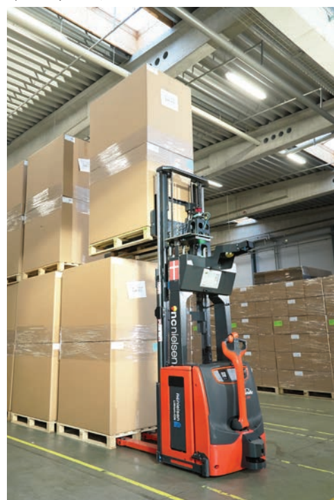
AGV-løsningen hos DAFA kan blokstable i det frie rum og placere varepaller oven på hinanden, så de op i en højde af 4,4 meter.
