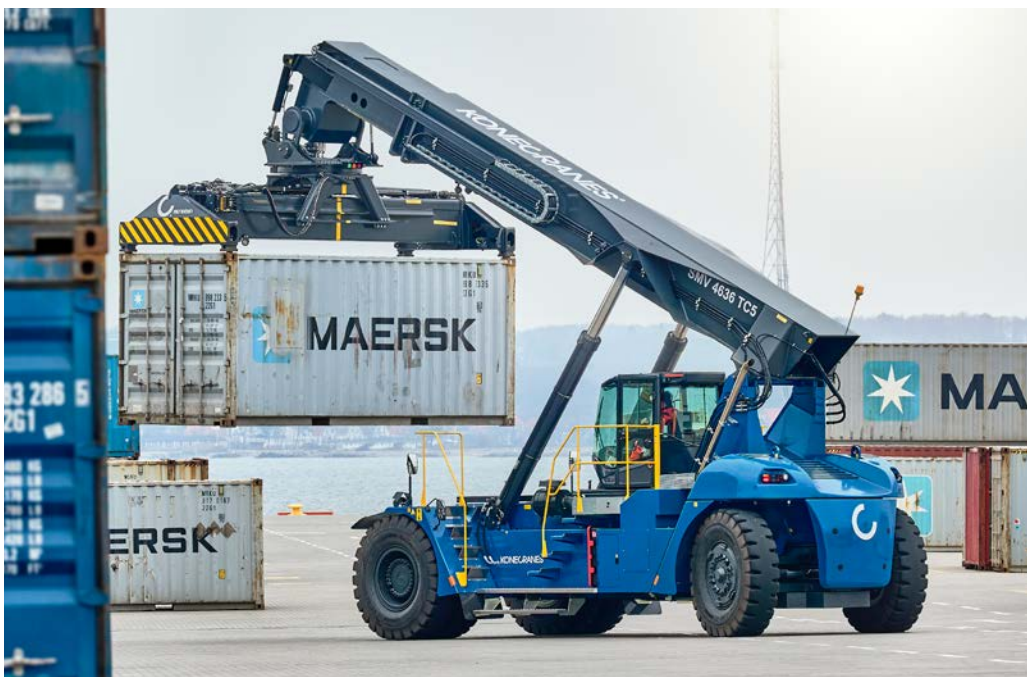
En Konecranes reachstacker med en løftekapacitet på 46 ton håndterer containere på den nyanlagte APM-containerterminal i Kalundborg Ny Vesthavn.
